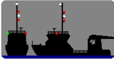
Für spezielle Anwendungen wie z.B. die Lichterführung ist es sinnvoll, Ausgänge in Gruppen zu schalten. Hier sind die Lichter an den Schaltbaustein einzelnen (Seitenlichter und Hecklichter gemeinsam) angeschlossen. Je nach anzuzeigendem Zustand sind die entsprechenden Ausgänge zu schalten. Als praktisches Beispiel betrachten wir doch einfach mal das nebenstehende Maschinenfahrzeug. Im Bild wird der Zustand 'manövrierbehindert mit Fahrt durchs Wasser' gezeigt. Für unser Beispiel
